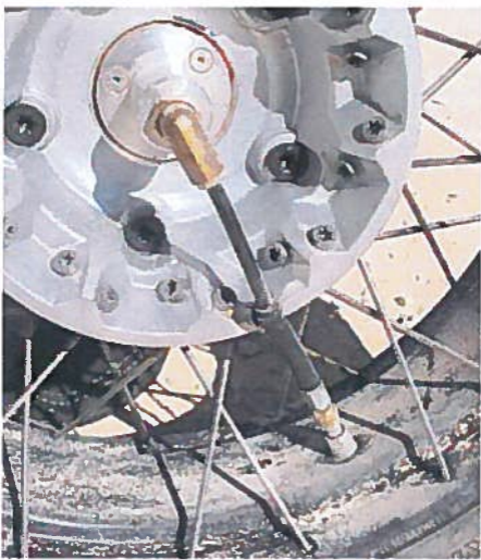
Das schlaucht: Verbindung zwischen Radnabe und Ventil
