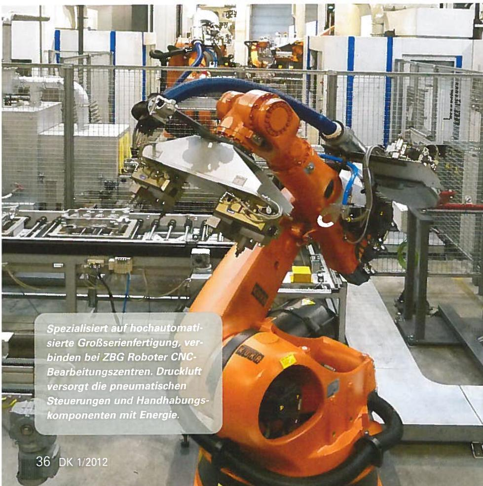
Spezialisiert auf hochautomatisierte Großserienfertigung, verbinden bei ZBG Roboter CNC-Bearbeitungszentren. Druckluft versorgt die pneumatischen Steuerungen und Handhabungskomponenten mit Energie.
